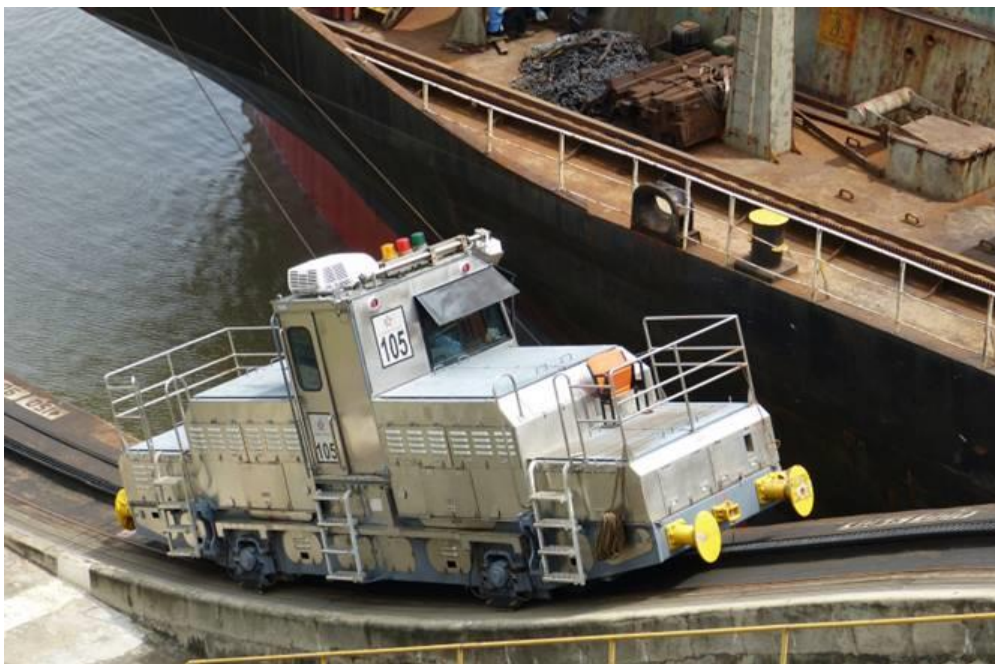
De gamla klassiska loken som drar och stabiliserar fartygen genom slussarna.
